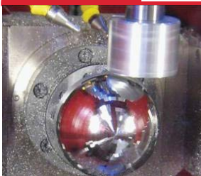
镜面铣削 材料: 铝 粗加工时间15分钟, 精加工时 间45分钟, 镜面粗糙度Ra0.0137μm
