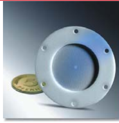
材料: 陶瓷 5156个孔, 直径0.13 mm 钻孔深度0.8mm 孔距公差±2 μm 每个孔加工时间7.8秒 一把刀完成
