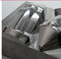
工模具加工 高精度, 五轴联动加工硬钢 硬度60-62HRC 硬铣削最佳光洁度Ra0.036
