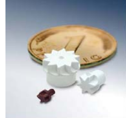
微量液体泵, 涡轮 材料: Vespel树脂和陶瓷 最小涡轮直径0.7mm 轮廓精度2μm 5轴联动加工
