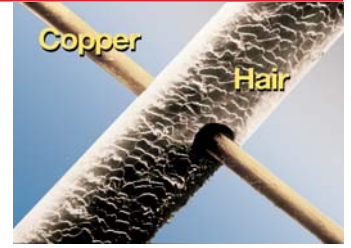
材料: 头发 直径60μm 钻5个孔 钻孔直径30μm
