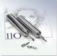
内窥镜刀 材料: 镍铬 5 轴加工, 宽度1mm, 长度4.5mm 12 把刀, 加工时间14 分钟, 要求 严格尺寸和优异的表面粗糙度
