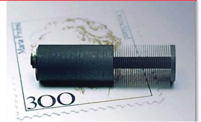
石墨电极加工 电极薄片壁厚: 0.1mm 电极薄片间距: 0.2mm 铣削加工, 加工时间5分钟 要求机床极小的震动
