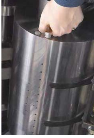
バキュームトランスポートシステム用コントロールバルブがツールなしで設定可能
