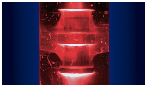
▲ カスケードソノトロード（特許取得済み）から放射するキャビテーション
