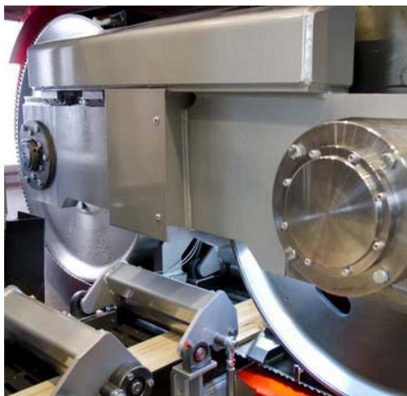
スピードライナー920-350 ハイブリッドの加工部
