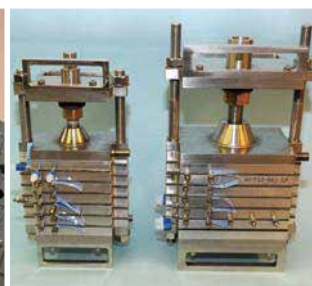
Plate Reactors A6 & A5 30～150&100～300mL/min
