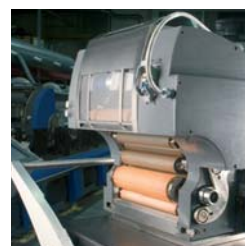
単純明快且つ信頼性におけるオフセット印刷ユニット。
