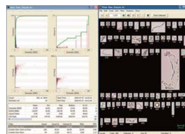
FlowCAMでの非経口製剤処方サンプル測定結果(>10μm以上の粒径の粒子画像を表示した例)
